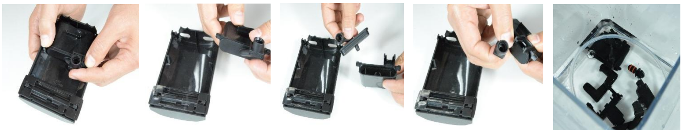
咖啡出嘴拆解成单个部件：双手大母指按住咖啡出嘴上的卡扣往上推，同时用食指向外扒出咖啡出嘴，取下咖啡出嘴胶套，取下咖啡出嘴。
