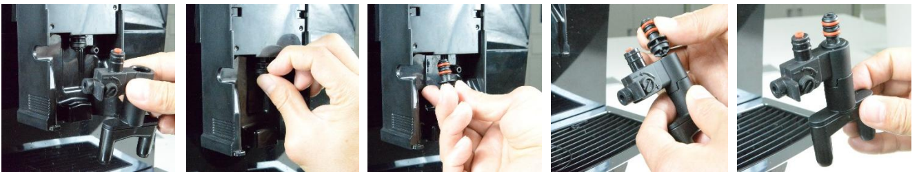
如上图所示：取下鲜奶加热腔和鲜奶出嘴组件、蒸汽喷嘴；把蒸汽喷嘴取下后插入鲜奶加热腔内，奶沫器组件拆卸完成。
