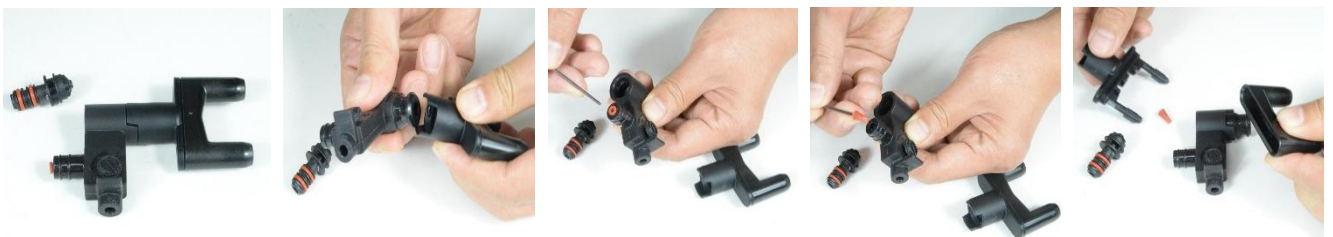
奶沫器拆解成单个部件：取下蒸汽喷嘴、分离鲜奶加热腔和鲜奶出嘴、取出鸭嘴单向阀、分开鲜奶出嘴密封盖和鲜奶出嘴。
